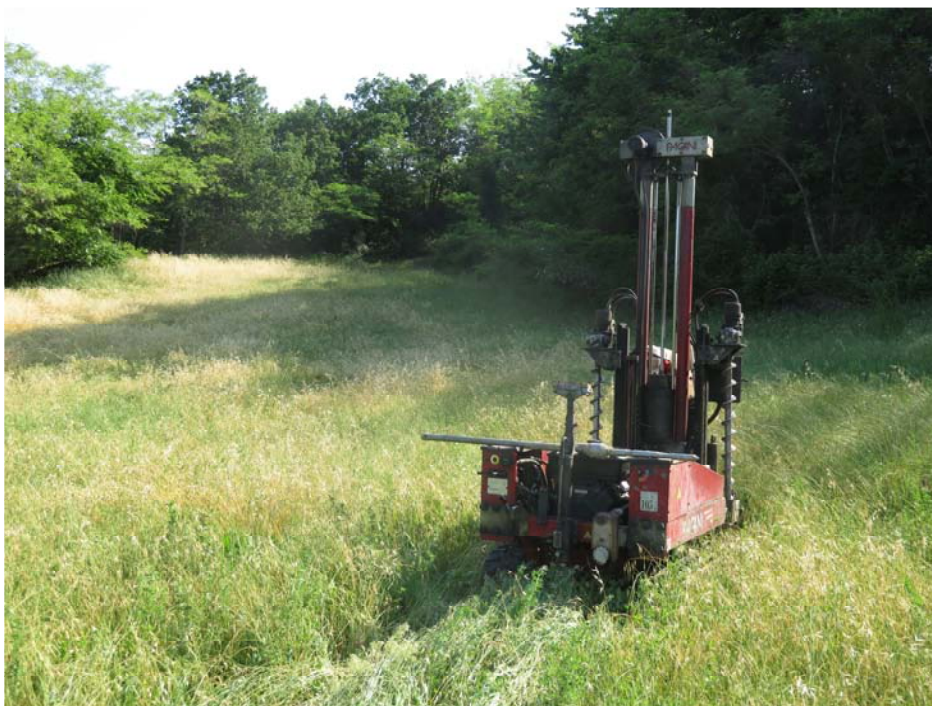
Fasi dell'esecuzione della prova penetrometrica CPT2
